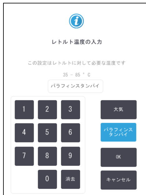
図 6-2:レトルト温度をパラフィンスタンバイ温度に設定する
